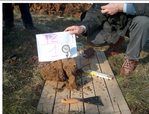
Campione di terreno prelevato alla profondità di 2.85 mt. dal piano campagna, sul quale sono state effettuate prove con il pochet penetrometer.
